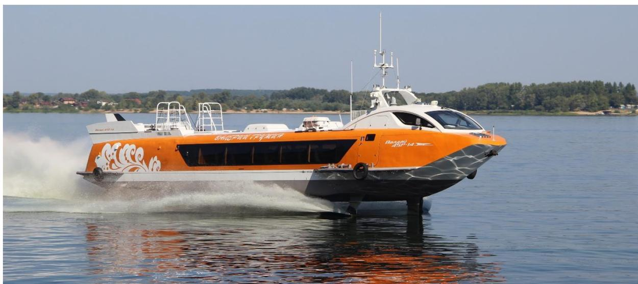
Рис. 1. Пассажирское скоростное судно на подводных крыльях «ВАЛЕРИЙ ГРУШИН»
